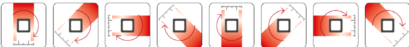
Sequenza di rilevazione delle dimensioni esterne del profilo durante un intero giro di rotazione della testa di misura.
