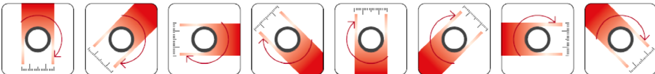
Sequenza di rilevazione delle dimensioni esterne del tubo durante un intero giro di rotazione della testa di misura.
